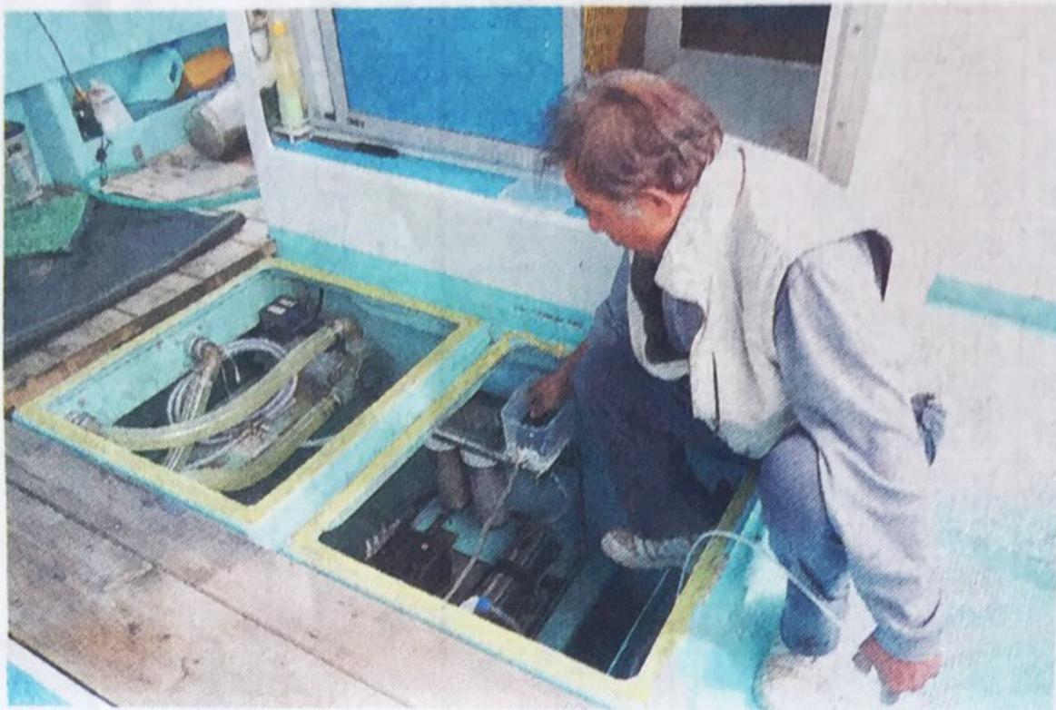
ソデイカ漁船・テレサ号船内に設置された海水淡水化装置。コンパクトなのでスペースを取らない。㊦は金城船主
