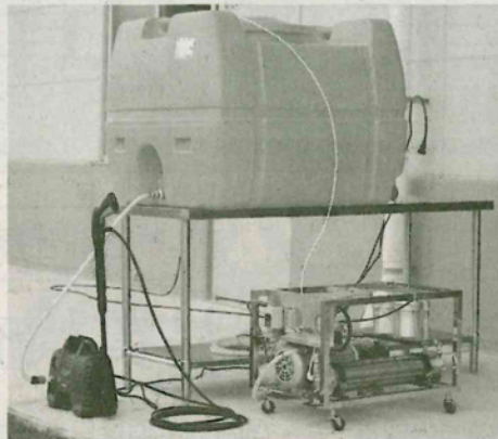
タンク①などをセットにした海水淡水化装置
