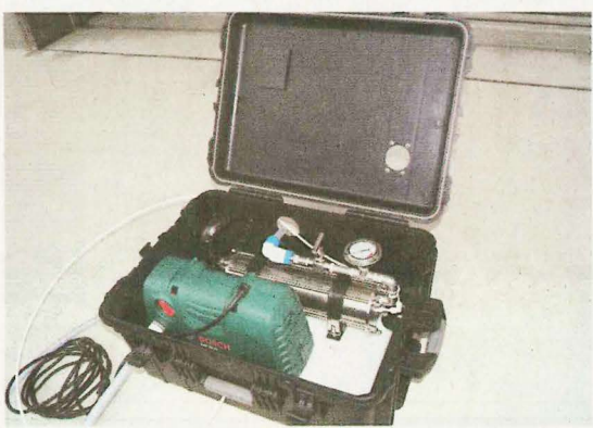
小型の海水淡水化装置「E-40H」の内部。逆浸透膜（RO）ユニットと電動の加圧機が納められている
