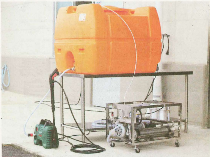
海水淡水化装置は利用の幅を広げている（建設機械の洗浄向けキット）
